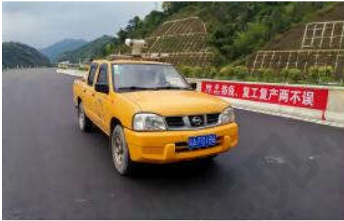
图 7.5.1-1 红外渗水状况检测车
