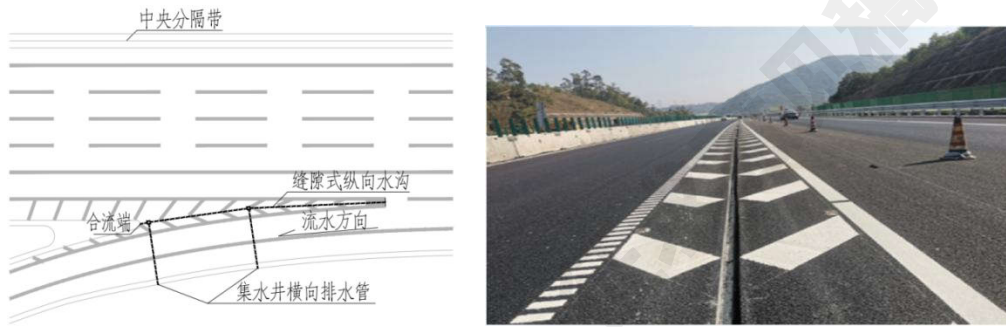
图 6.4.4.1 立交分合流段 设置纵向排水示意图
