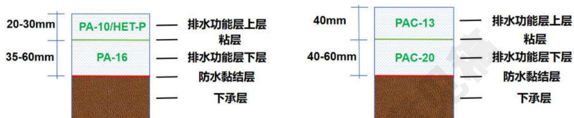
图 7.1.3-2 双层排水沥青路面典型结构示意图
