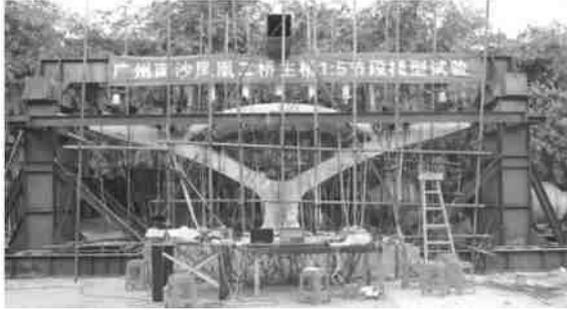
图9 节段试验模型
