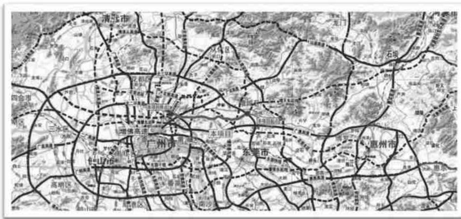
本项目总体为东西走向,路线起点位于增城区朱村街道,接北三环高速,终点接知识城快线(规划),并与增佛高速公路天河至佛山段顺接,全长约38 km,沿线设互通立交11座(含规划预留),服务区1座,养护工区、管理中心和集中住宿区各1处。项目沿线联系增城主城区、增城国家级开发区、黄
