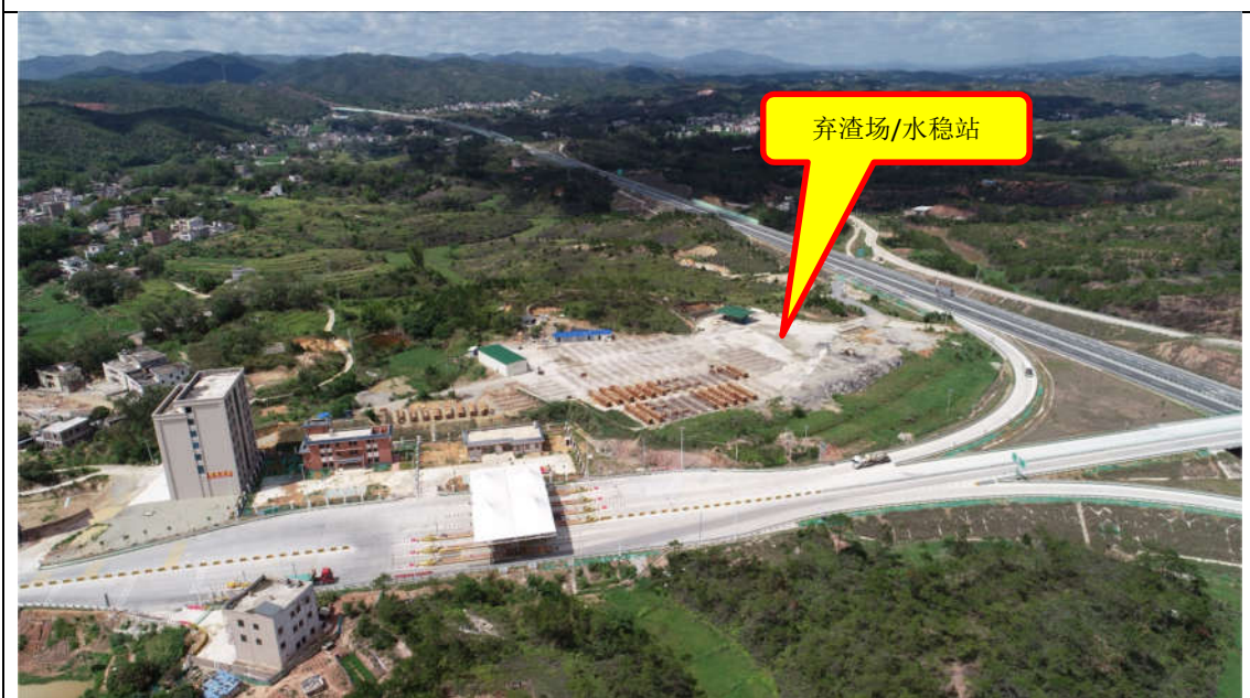
TJ2 标 1#弃渣场 (弃渣完成后路面标作为水稳站, 完工后移交)
