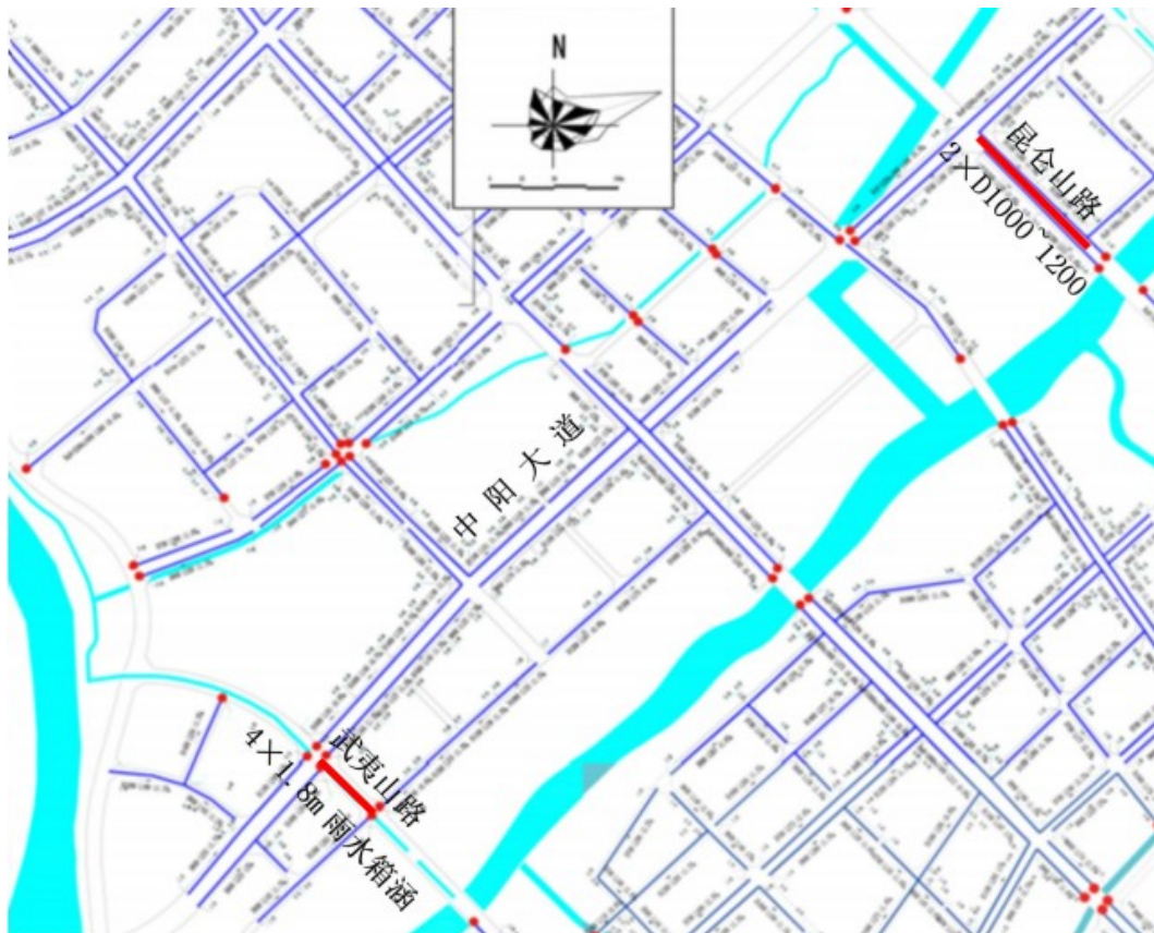
图 1-6 昆仑山路和武夷山路雨水管网图
