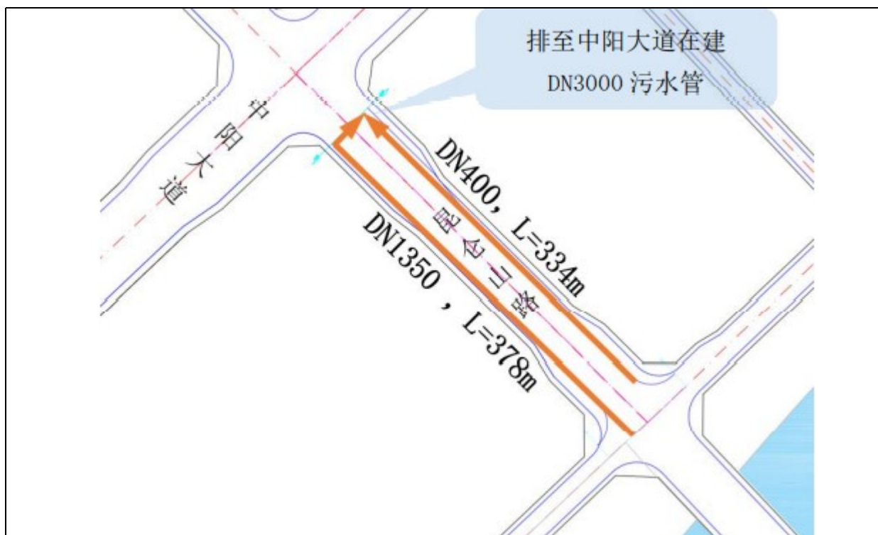
图 1-13 昆仑山路污水工程设计图
