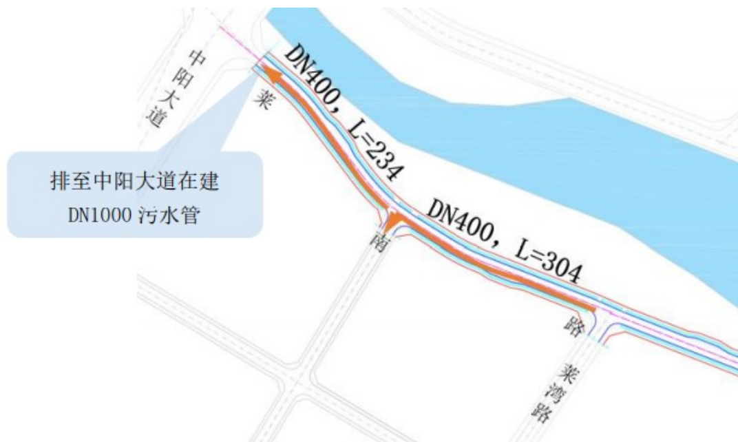
图 1-15 莱南路污水工程设计
