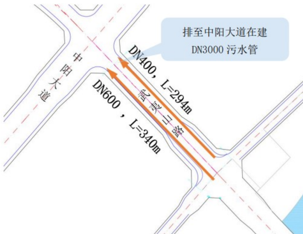
图 1-12 武夷山路污水工程设计图
