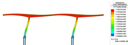
图11 二阶失稳模态:顺桥反对称竖弯,临界系数为38.39
