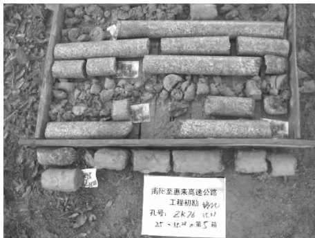
图2 钻孔揭露的花岗岩孤石
