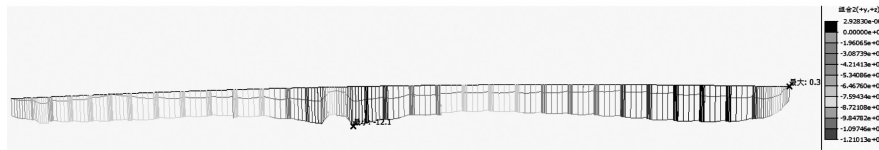
图 7 荷载效应长期组合作用下主梁上缘应力图
